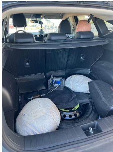
Ilustración 10. Vehículo con carga de 285 kg (incluye conductor, acompañante, dummie y bolsas de arena)
