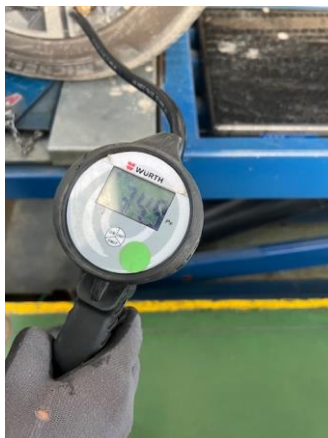
Ilustración 9. Verificación presión de neumáticos
