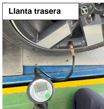
Ilustración 9. Verificación presión de neumáticos
